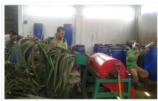
Gambar 18. Penggilingan Pelepah Sawit Menggunakan Mesin Shreeder
