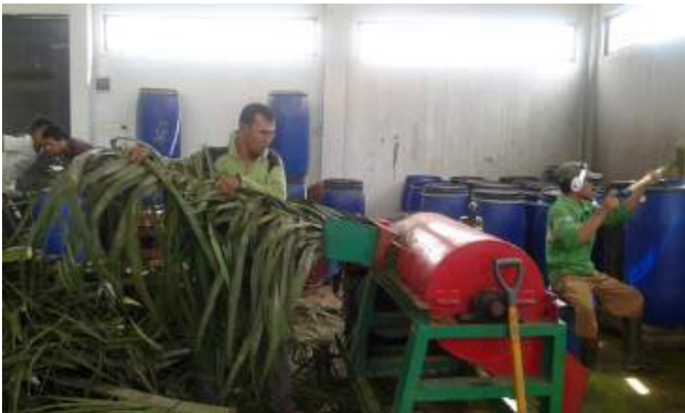
Gambar 22. Penggilingan pelepah sawit menggunakan mesin shreeder
